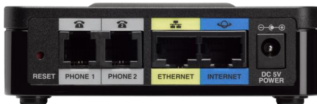
Abbildung 2. Anschlüsse beim Cisco SPA122 ATA mit Router
